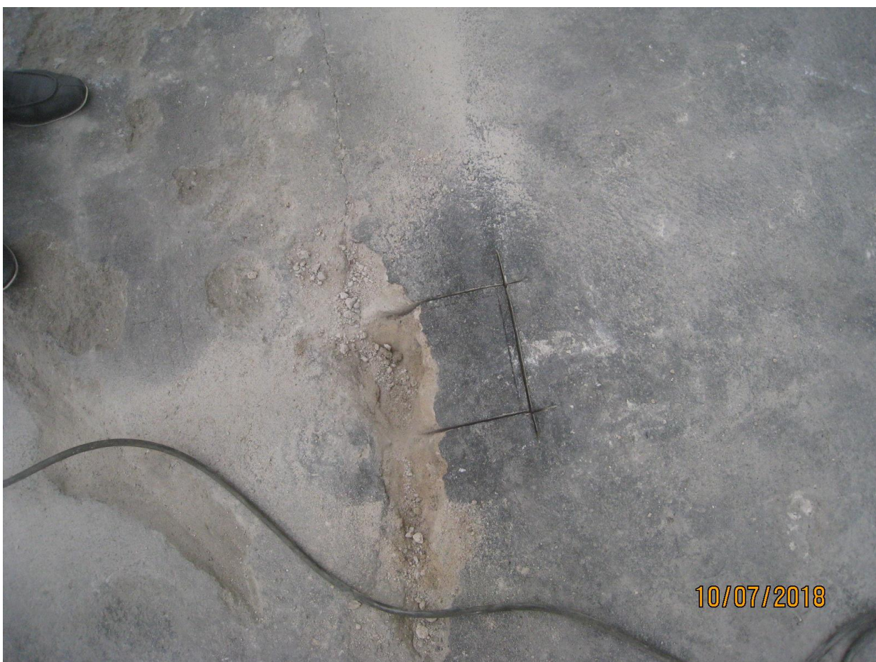
2018-07-10 d. apžiūros metu buvo paimtas cementinio skiedinio bandinys bandymams laboratorijoje (žr. nuotrauką Nr. 18)
